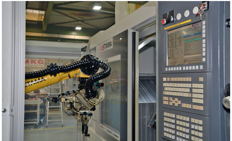
5 Ergänzt um einen Belade- und Entladeroboter kann das Bearbeitungszentrum MC 531 TWIN der Marke Stama mehrschichtig bedienerlos fertigen © Hanser
